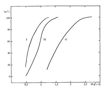
Abb. 1 Prozentuelle Häufigkeitsverteilung [Summenkurve] n täglicher Abflußstärke in Prozent durchschnittlicher Abflußstärke Q für Gaslandsvatnet, Malangsfoss und Jotkajavrre. Januar und Februar 1953—1962.
