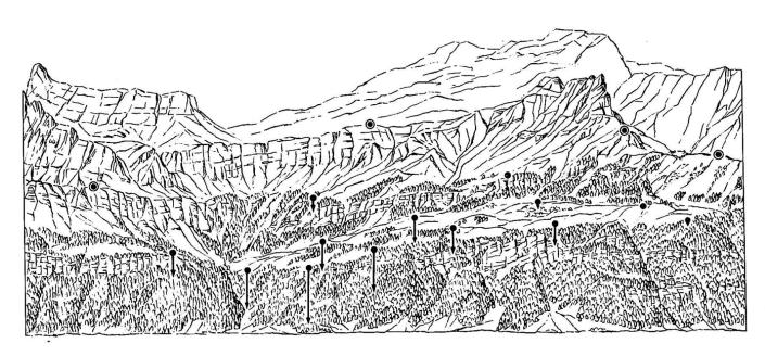
Fig.1 Die Terrasse von Braunwald im Linthtal. Die Pfeile geben die mittlere jährliche Höhenverschiebung eingemessener Punkte der Periode 1925—1954 an. Die Beträge schwanken zwischen 3 und 16 mm pro Jahr. Horizontalverschiebungen von 1—42 mm pro Jahr (aus Kobold 1959).
