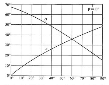
Fig. 9 Die Winkel  $\alpha$  und  $\delta$  (Ordinate) als Funktion des Böschungswinkels  $\beta$  (Abszisse) für  $\varphi = 0$  (nach Fellenius 1927).
