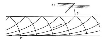
Fig. 6 Aktiver (a) und passiver (b) Rankine-Zustand.
