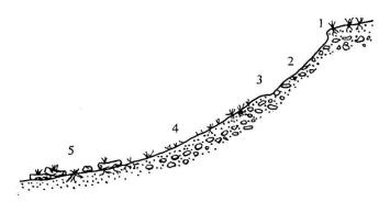
Fig. 4 Rasengleiten. 1 Abrißkante, 2 Gleitbahn auf Moräne, 3 Stauchwall, 4 Gleitbahn auf Rasen, 5 Rasenschollen und einzelne Gerölle am Hangfuß.
