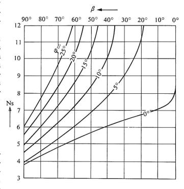
Fig. 8 Stabilitätsfaktor  $N_8$  als Funktion vom Böschungswinkel  $\beta$  (nach Fellenius 1927).
