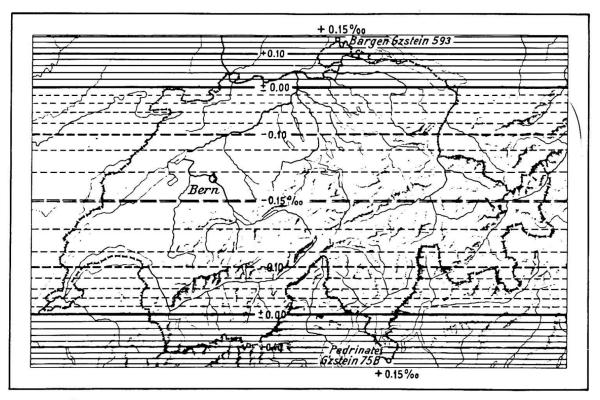
Figur 3: Äquideformaten der Flächenverzerrung bei winkeltreuer Projektion auf einen Schnittzylinder mit maximaler Flächenverzerrung von ± 0.15 %
