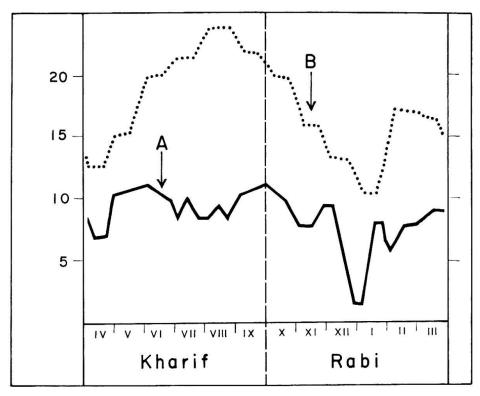
Fig. 3. Wasserbedarf und Wasserverbrauch im Punjab. A Effektiver Wasserverbrauch, B Errechneter Bedarf der Kulturen. Angaben in 1000 cusec (1 cusec = 102 m³/h).
