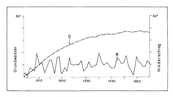
Fig. 4. Vergleich von Niederschlag (N) und Höhe des Grundwasserspiegels (G).
