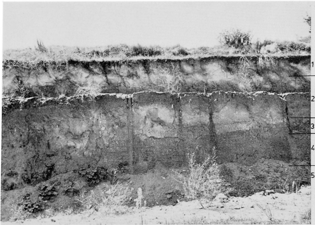
Abb. 22. Der Lößaufschluß der Aktien-Ziegelei Allschwil (vgl. Abb. 23). 1 Humus und Lehm, 2 Löß mit einer dünnen Lehmzwichenschicht, 3 Lehm, 4 Löß, 5 Lehm. Durch Bohrung konnten noch Lehm und darunter Löß auf Schotter festgestellt werden. Weitere Angaben im Text.
