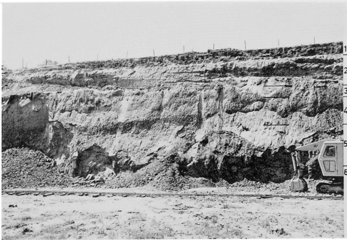
Abb. 19. Der Lößaufschluß von Passavant-Iselin & Cie. AG., Allschwil (vgl. Abb. 24, Säule 1). 1 Humus und Lehm, 2 Löß mit einer dünnen Lehmzwichenschicht, 3 Lehm, 4 Löß, 5 Lehm, 6 Löß. Weitere Erläuterungen im Text.
