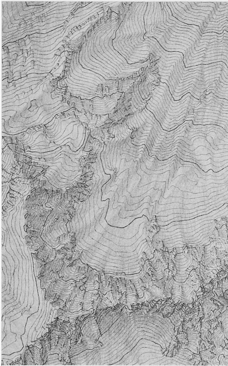
Abb.15 Ausschnitt aus dem Übersichtsplan Val d'Arpetta. Dzennepi. Äquidistanz 10 m. Felskurven, Felslinien und Reliefton. Zeichnung und Bemalung vom Verfasser. Im Gegensatz zu Abb.13 enges Kurvensystem und engere Felslinienzeichnung, was der Skizze mehr kartographisches Gepräge verleiht. Verkleinert
