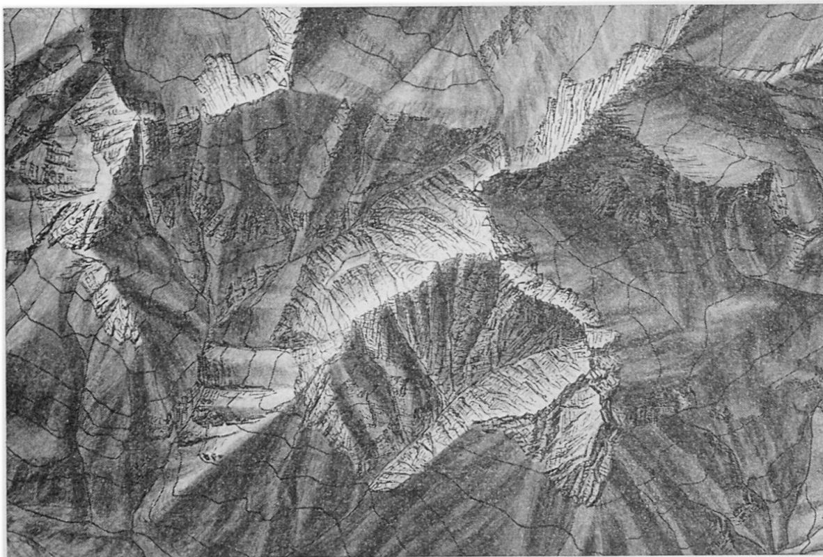
Abb. 2 Ausschnitt aus einer Kartenskizze, in welcher der Reliefton in schiefer Beleuchtung über eine offene Felsschraffen-Zeichnung gelegt ist. Zeichnung und Bemalung vom Verfasser auf Grund des französischen 20 000 stels (Westalpen). Verkleinert (zu stark)
