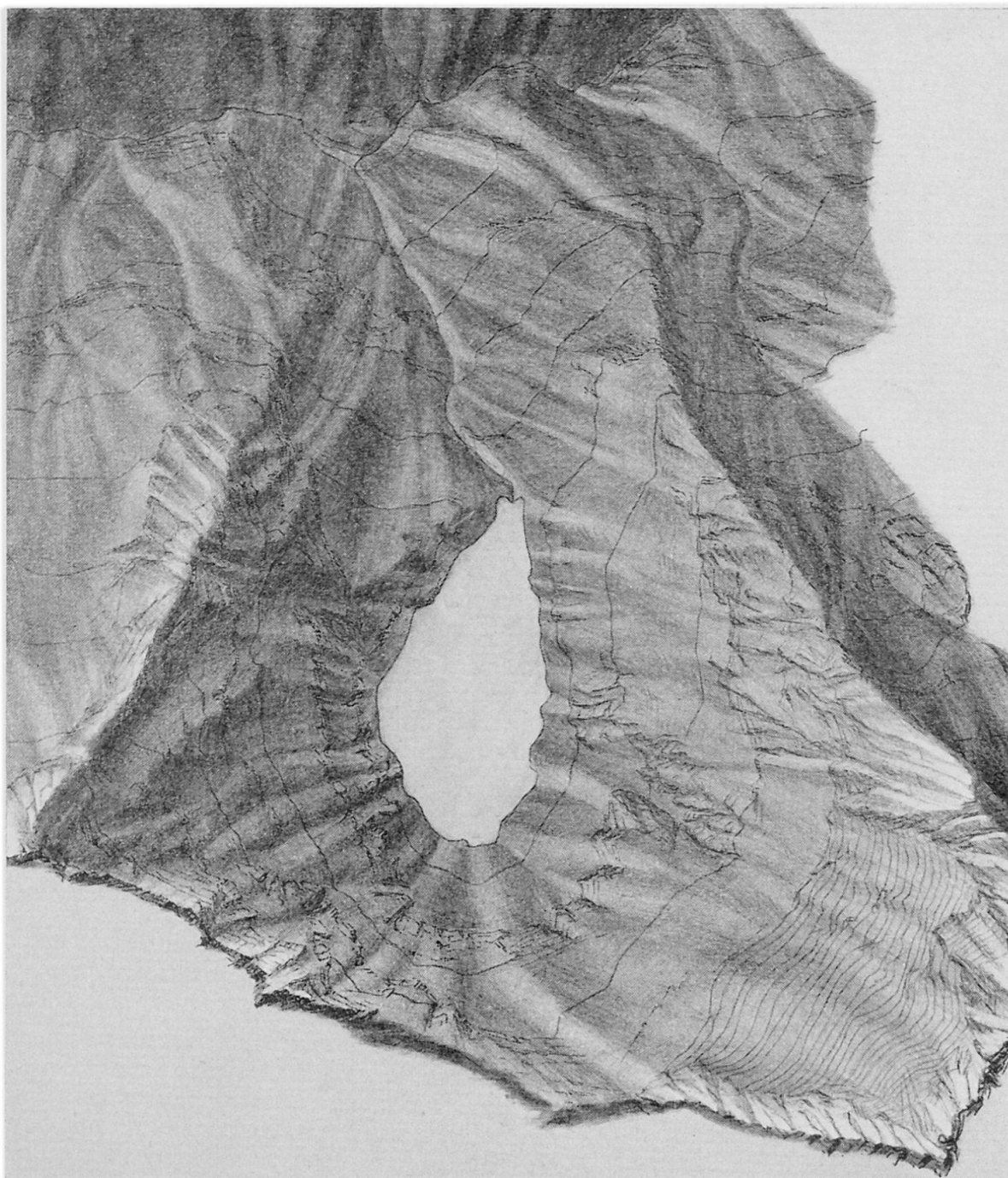
Abb.3 Ausschnitt aus dem Übersichtsplan Chironico. Laghetto-Trog am Übergang aus der Val Chironico (Val Leventina, Tessin) in die Val Verzasca (Sonogno). Offene Felsschraffenzeichnung. Reliefton in schiefer Beleuchtung über die ganze Skizze. Zeichnung und Bemalung vom Verfasser. Verkleinert
