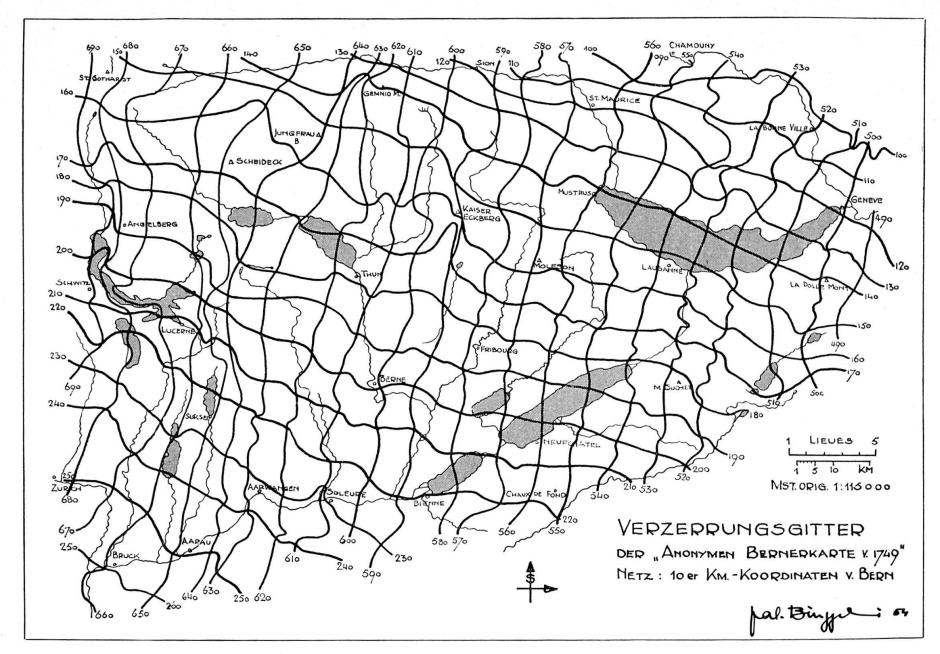
Fig. 1 Anonyme Bernerkarte von 1749. Verzerrungsgitter zur Untersuchung und Darstellung der geodätischen Genauigkeit. (Grundlage: Dufourkarte, z.T. neue Landeskarte.) Das wandkartengroße Gitter wurde photographisch ca. 7 x verkleinert. (Hier ca. 1:10.)
