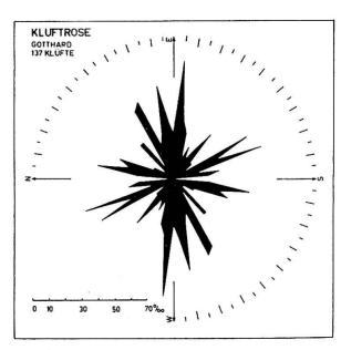
Fig. 6: Verteilung der Klüfte im Fibbia-Granit der Gotthardpaßhöhe. – Darstellung der Streichrichtungen in Polarkoordinaten.
