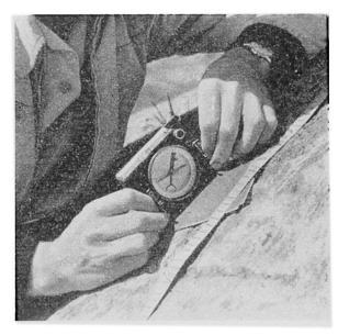
Abb. 11: Oberflächenmessung an Rundhöckern.
