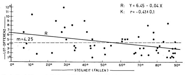
Fig. 8: Vergleich von Steilheit und Ebenheit großer Kluftflächen. R = Regressionsgerade für kleinste Ordinatenquadrate. K = Korrelation. r = Korrelationskæffizient. m = Arithmetisches Mittel der Lotdifferenzen in Grad. Der Ordinatenmaßstab ist 2,5 mal größer als der auf der Abszisse.
