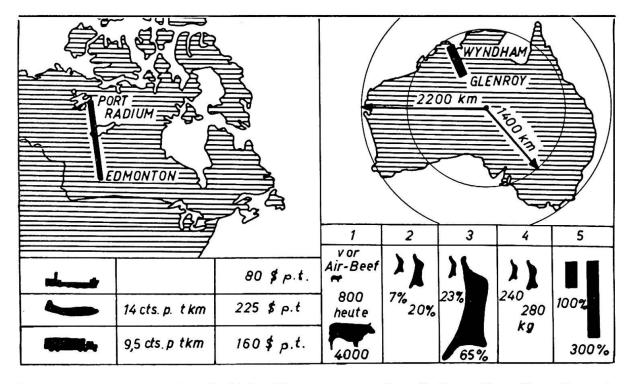
Beispiele der "Outback Aviation". Links: Versorgung von Port Radium. Gegenüberstellung der Kosten pro Tonnenkilometer und pro Tonne für Schiff-, Luft- und Straßentransport. Rechts: Experiment "Air-Beef" 1 jährlich geschlachtete Stück Vieh, 2 zur Verarbeitung gelangtes Vieh in <sup>0</sup>/<sub>0</sub> von 1, 3 Anteile der Exportqualität am produzierten Fleisch, 4 mittleres Gewicht pro Stück Vieh, 5 Gewinnvergrößerung durch "Air-Beef".
