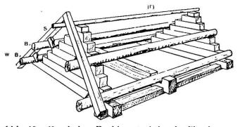
Abb. 40 Gemischte Dachkonstruktion in Cimalmotto
