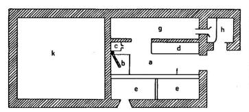
Abb. 28 Alphütte auf Großalp: a = Milchverarbeitungs- und Aufenthaltsraum, b = Feuerstelle mit Turner, c = Käseblock, d = Gestelle, e = Alphetten, f = Bank, g = Milchkeller mit Gestellen, h = Schweinestall, i = unten in den Hang eingeschnitten: der Stall, k = Hüttenteil der zweiten Familie.
