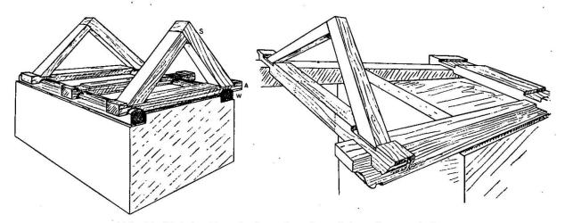
Abb. 36 (links) Der Aufbau des eigentlichen Sparrendaches Abb. 37 (rechts) Sparrenkonstruktion mit Vordach. Der Ankerbalken am Vordach kann unterbrochen sein, sodaß als Sparrenträger nur zwei Stichbalken übrig bleiben
