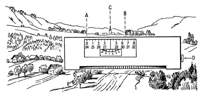
Seitenwinkel- und Azimutmessung mit dem Sitometer. Der Seitenwinkel A-B beträgt 650A%, das Azimut von C = 120%, Ost. Das Skalenfenster ist hier im Interesse der Deutlichkeit zu groß gezeichnet. Es ist bei der Messung ganz ans Auge heran zu nehmen. Arretierknopf bei D hineindrücken (Abbildung 312, Seite 200).
