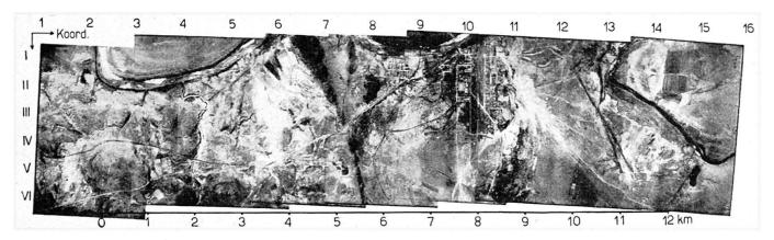
Fig. 14: Luftbildplan, zusammengesetzt aus 9 Senkrechtaufnahmen (Originalmaßstab 1:20000) Gebiet am Oranje-Fluß
