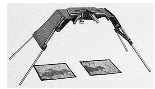
Fig. 121: Das Klapp-Spiegelstereoskop
