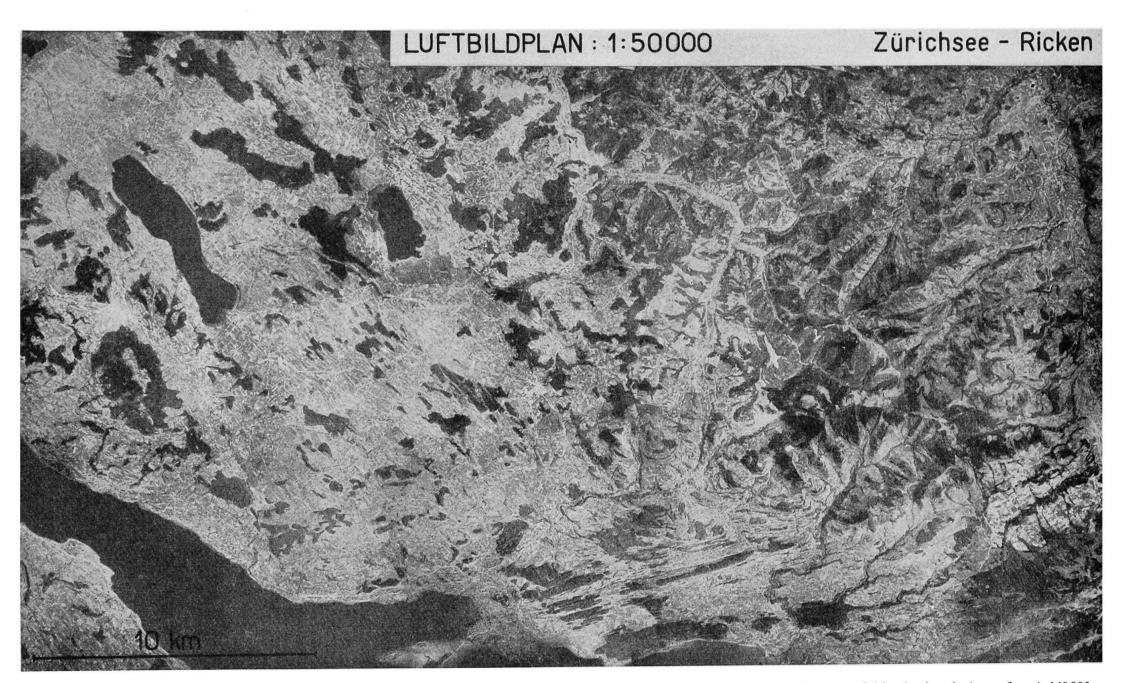
Fig. 45: Luftbildplan, zusammengesetzt aus 27 entzerrten Senkrechtaufnahmen der Eidg. Landestopographie; alle Rechte vorbehalten. Bildmaßstab reduziert auf ca. 1:160 000.
