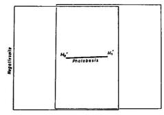
Fig. 116: Der Hauptpunkt. Die Strecke H<sub>1</sub>—H<sub>2</sub> bezeichnet die Aufnahmebasis, die Strecke H<sub>1</sub>'—H<sub>2</sub>' die Photobasis (= Aufnahmebasis im Bildmaßstab).
