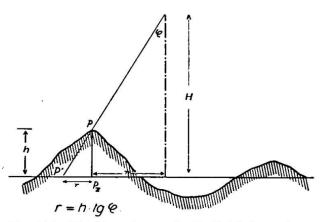
Fig. 115: Die Entstehung der Radialdeformation r (im natürlichen Maßstab des Geländes dargestellt).
