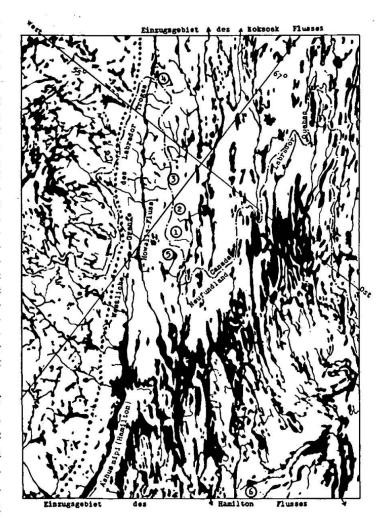
Fig. 3. Ausschnitt aus der Karte des Labrador-Eisendistrikts, gezeichnet auf Grund photographischer Aufnahmen. Die Zahlen 1—6 bezeichnen einige der bis jetzt bekannten Lager: 1 Burnt-Creek-Lager, 2 Ferriman-Lager, 3 Fleming-Lager, 4 Goodwood-Lager, 5 Ruth-Lager, 6 Sawyer-Lager. Die Lager 1—5 sind Oberflächenlager und liegen der Wasserscheide entlang; das Sawyer-Lager ist wahrscheinlich ein residuelles Lager, wurde aber vom Verfasser nicht besichtigt
