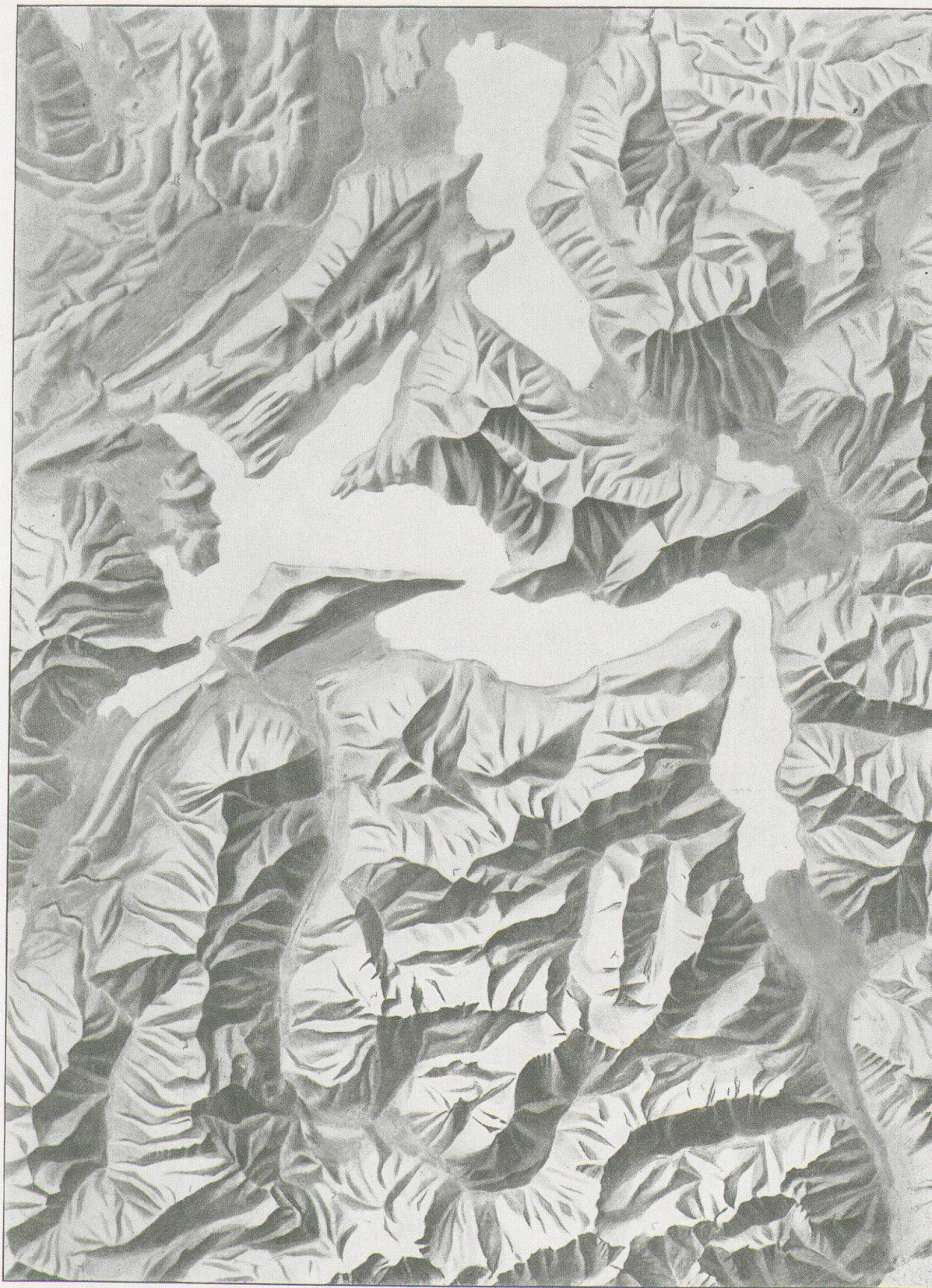
Abb. 5. Reliefvorlage für die Karte der Zentralschweiz 1:200 000, (Mittelschulatlas 1948, Seite 1). Die Abbildung ist auf die Hälfte des Originals reduziert.
