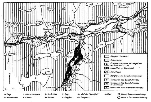
Abb. 4. Die hauptsächlichsten Terrassen und der verfestigte Schotter des Niedersimmentals. Die Terrassen des Burgfluhniveaus im Diemtigtal (BD) sind gegenüber denjenigen des Haupttales infolge späterer erneuter Erosion etwas niedriger
