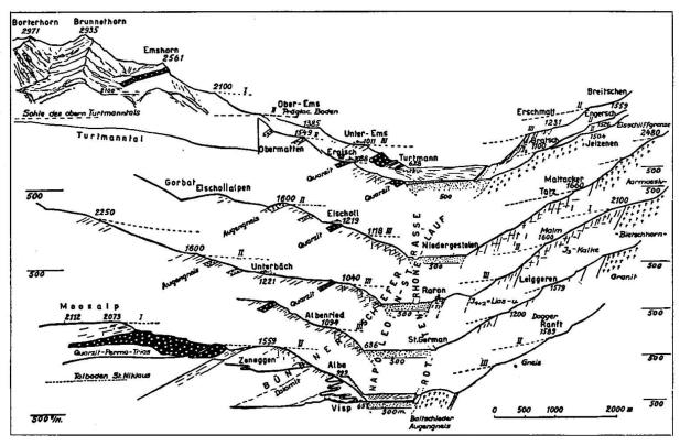
Fig. 2. Querprofile durch das Rhonetal zwischen Turtmann und Visp, mit Angabe der Felserosionsterrassen J, II, III. I pliocān; II entspricht der Höhenlage des Prāglazialen Talbodens am Borter- und Emshorn Kar in I.
