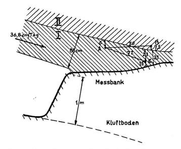
Fig. 2. Anordnung zur Geschwindigkeitsmessung.
