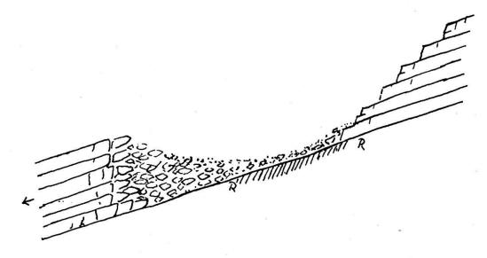
Abb. 7. Terrassenbildung zwischen abgerutschten und zurückgebliebenen Felslagen, dargestellt im einfachsten Fall. Bei der Alpe Lareggio ging das Abrutschen nach links sehr viel weiter, auch ist offenbar eine Umgestaltung durch Eis und Firn eingetreten. RR: Rutschsläche.
