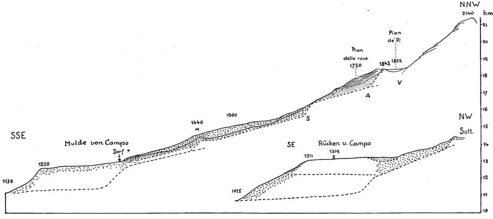
Abb. 10. Längsprofil durch den Trümmerstrom von Pian de' Pi bis Campo und durch die Terrasse bis zur Rovana 1:15 000.
