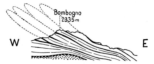
Abb. 4. Ausschnitt aus einem geologischen Profil O. Grütters 1:37 500. Weiß: Gneise, schwarz: sandig-kalkiges Mesozoikum (Quarzite und Schiefer), punktiert: hornblendeführende Schiefer (Amphibolite). Das Fallen ist nach ESE—SE gerichtet.
