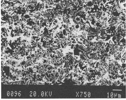
**Abb. 30:** Rückstreuelektronenbilder (Röntgenmikrosonde) des Inneren eines Silberdirhams.
