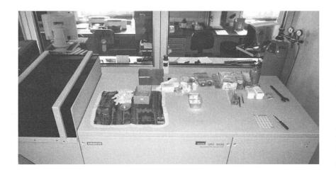
Abb. 13: Wellenlängendispersives Röntgenspektrometer, seit 1998 in Betrieb.
