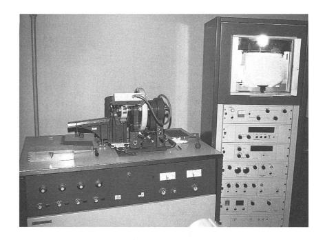
**Abb. 17:** Manuelles Röntgendiffraktometer, von 1968 bis 1985 in Betrieb.
