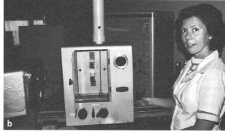
**Abb. 10:** Gitterspektrograph, im Geochemischen Labor Basel 1958 bis 1975 im Einsatz, zunächst für die Bestimmung von chemischen Hauptkomponenten in silikatischen Gesteinen und Mineralien, später für die Analyse von Spurenelementen.
