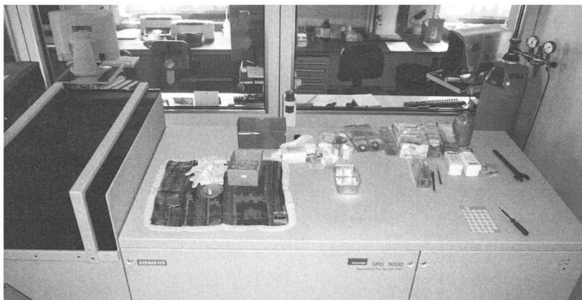
Abb. 13: Wellenlängendispersives Röntgenspektrometer, seit 1998 in Betrieb.
