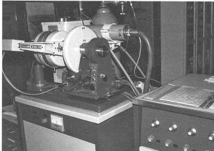
**Abb. 12:** Handgesteuertes sequentielles Röntgenspektrometer, 1971 bis 1985 zur Analyse von chemischen Haupt- und Nebenkomponenten sowie einzelner Spurenelemente eingesetzt.
