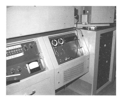
Abb. 11: Gitter-Simultanspektrometer, «Atomcounter», 1963 bis 1973 zur Analyse von chemischen Haupt- und Nebenkomponenten in Silikaten verwendet.
