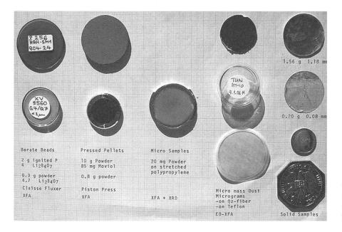
Abb. 16: Verschiedene Präparationsformen/ «Darreichungsformen» für die XFA.
