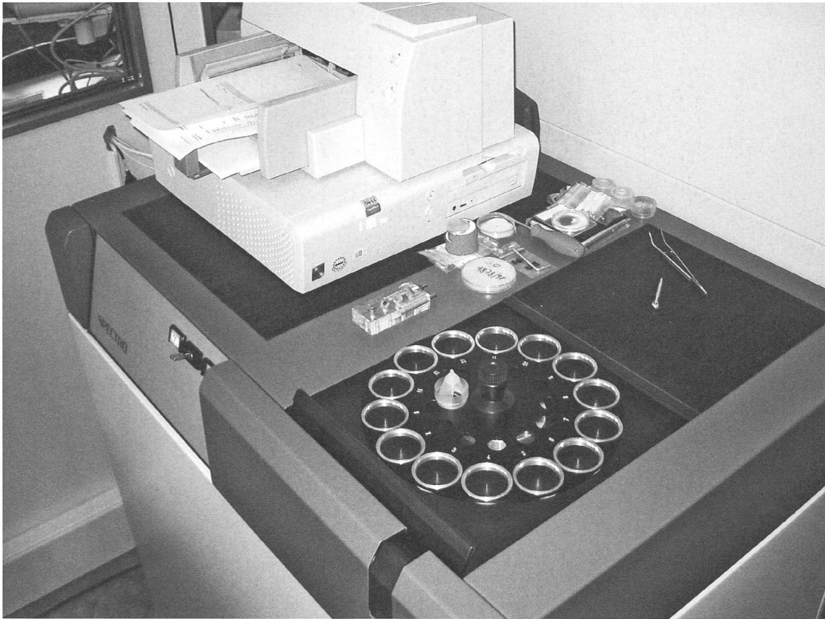
Abb. 14: Energiedispersives Spektrometer, seit 2000 in Betrieb.
