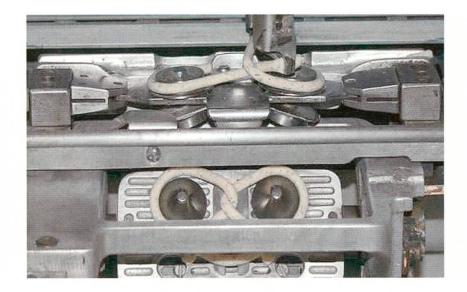
Abb. 54 Moderne automatische Brezel-Schlingmaschine.
