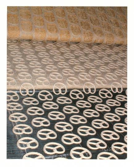
Abb. 61 MAYKA-Brezel-Produktionslinie. Oben wird der Restteig nach dem Ausstanzen der Brezeln zurückgefahren und rezykliert.
