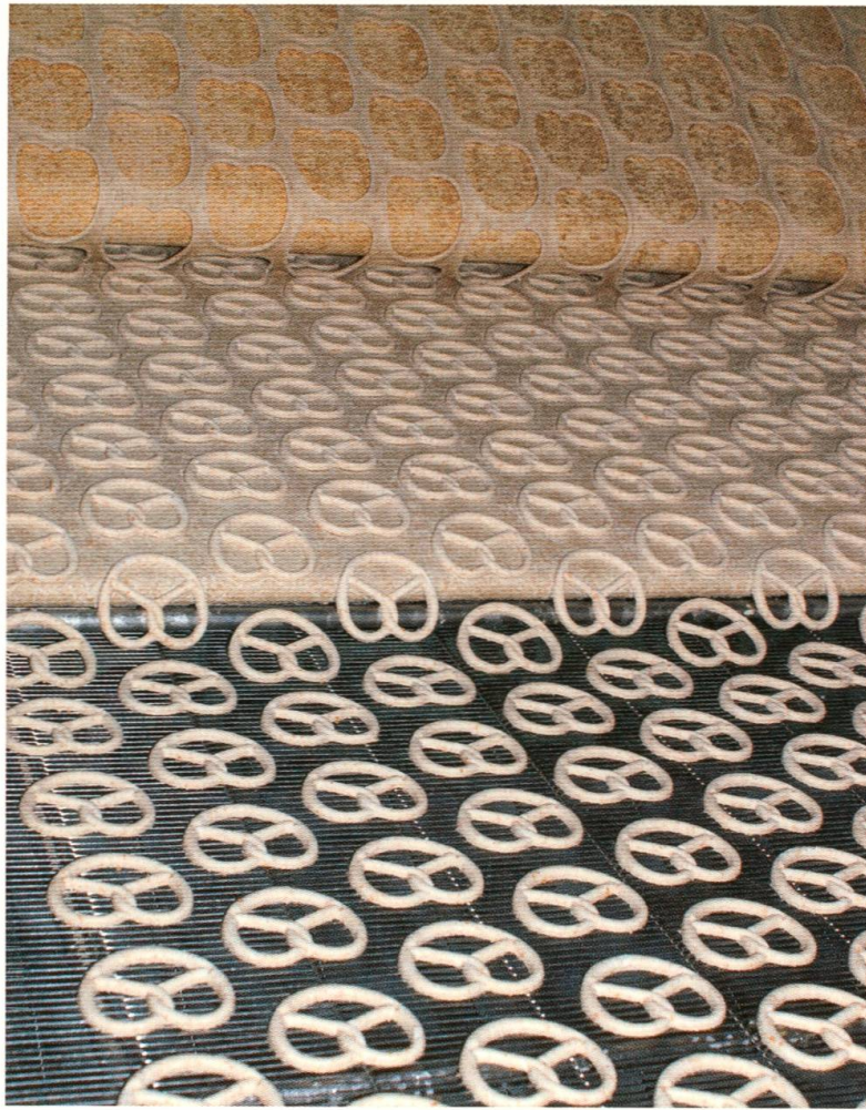
Abb. 61 MAYKA-Brezel-Produktions- linie. Oben wird der Restteig nach dem Ausstanzen der Brezeln zurückgefahren und rezykliert.
