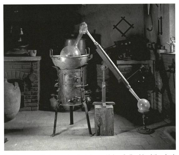
Destillierapparatur. Die Trennung eines Gemisches verschiedener Stoffe erfolgte früher oftmals mittels Destillation. Unterschiedliche Stoffe können verschiedene Siedepunkte besitzen, daher ist eine Trennung anhand dieser physikalischen Eigenschaft möglich, gleichzeitig aber auch eine Charakterisierung anhand des Siedepunktes.
