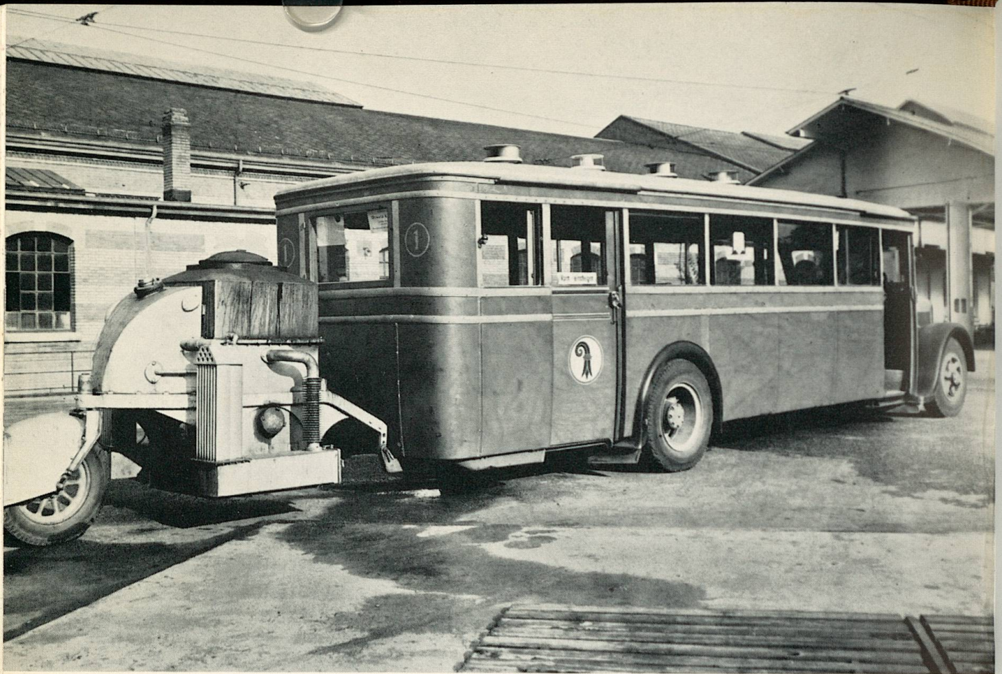
Autobus 1 (Saurer, Arbon/Reinbolt & Christe, Basel) aus dem Jahre 1930, wurde 1959 an die Ciba verkauft. Während des Zweiten Weltkrieges betrieb man ihn mit Holzgas.
