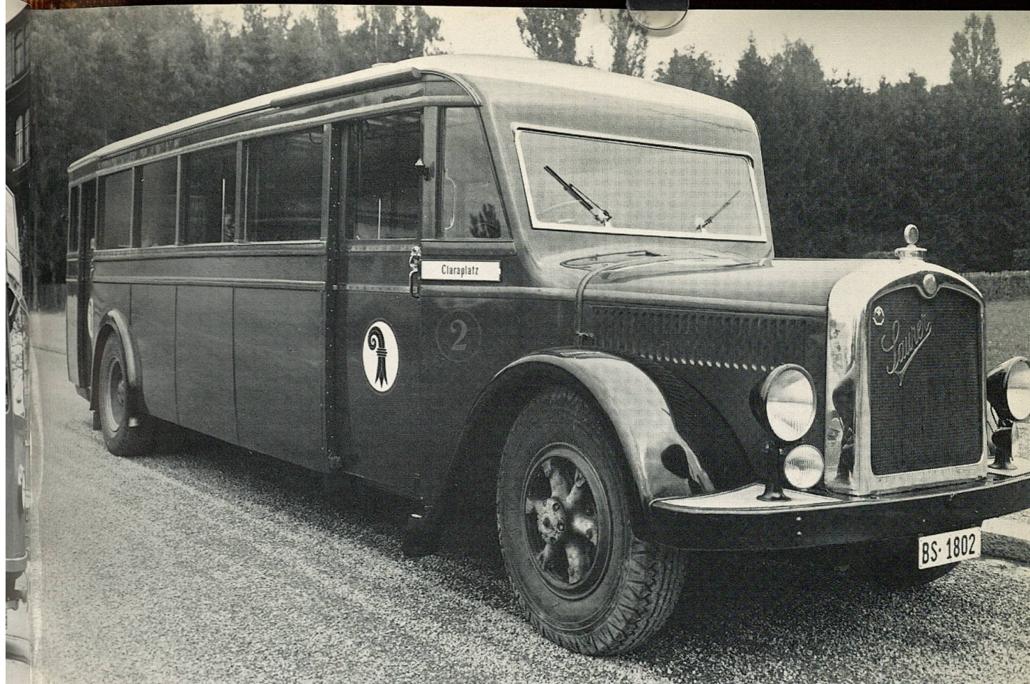
Autobus 2 (Saurer, Arbon/Reinbolt & Christe, Basel) aus dem Jahre 1930. Dieser Wagen wurde beim Garagebrand vom 12. Januar 1940 schwer beschädigt und in der Folge zum Trolleybus Nr. 52 umgebaut.
