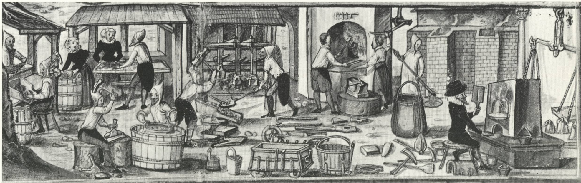
XII. Aufbereiten des Erzes durch Ausschlagen, Klauben und Pochen sowie Waschen, Schmieden, Schmelzen und Probieren des Eisens.
