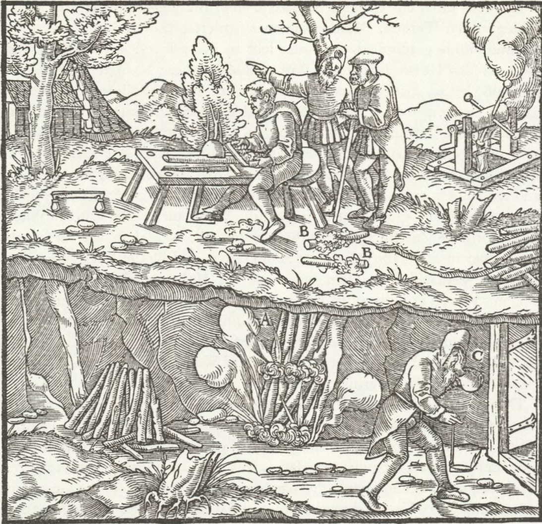
Abbau des Erzes durch Feuersetzen
