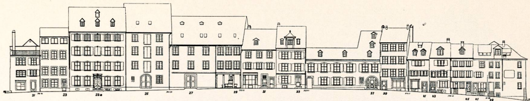
Abb. 17. Altstadt-sanierung. Fassaden-aufnahmen (bestehender Zustand) Nadelberg 21-49.
