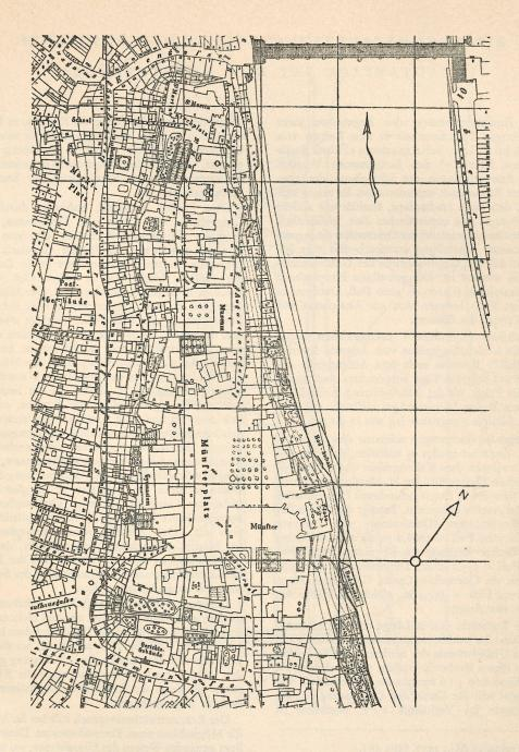
Abb. 17. Das römische Vermessungsnetz auf dem Münsterhügel in einem Ausschnitt aus dem Stadtplan von L. A. Loeffel, aus den Jahren 1857–1859. Einer Quadratseite des Netzes entsprechen zwei römische Actus = 1/10 Centurie = 71 m
