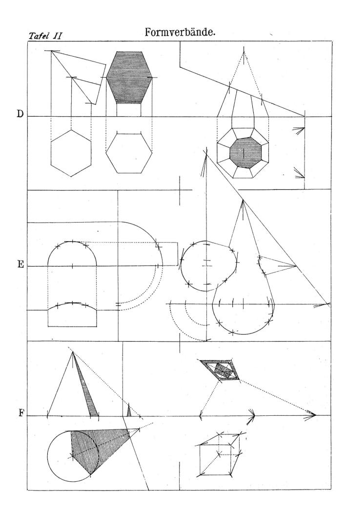
Wie die Bestimmung der Eigen- und Schlagschatten auf der Einrichtung des Körpers in ein Bündel paralleler Strahlen besteht, erke nt man deutlich am Kegel, dessen Eigenschatten durch die beiden Berührebenen gegeben ist, welche der Lichtstrahl durch die Spitze des Kegels bestimmt, indem die Tangenten aus dem Stosspunkt dieses Strahles mit der Grundfläche zum Leitkreis des Kegels die Spuren dieser Berührebenen und zugleich die Schlagschatten des Kegels sind, wie man auf dem Feld E1 sieht.
