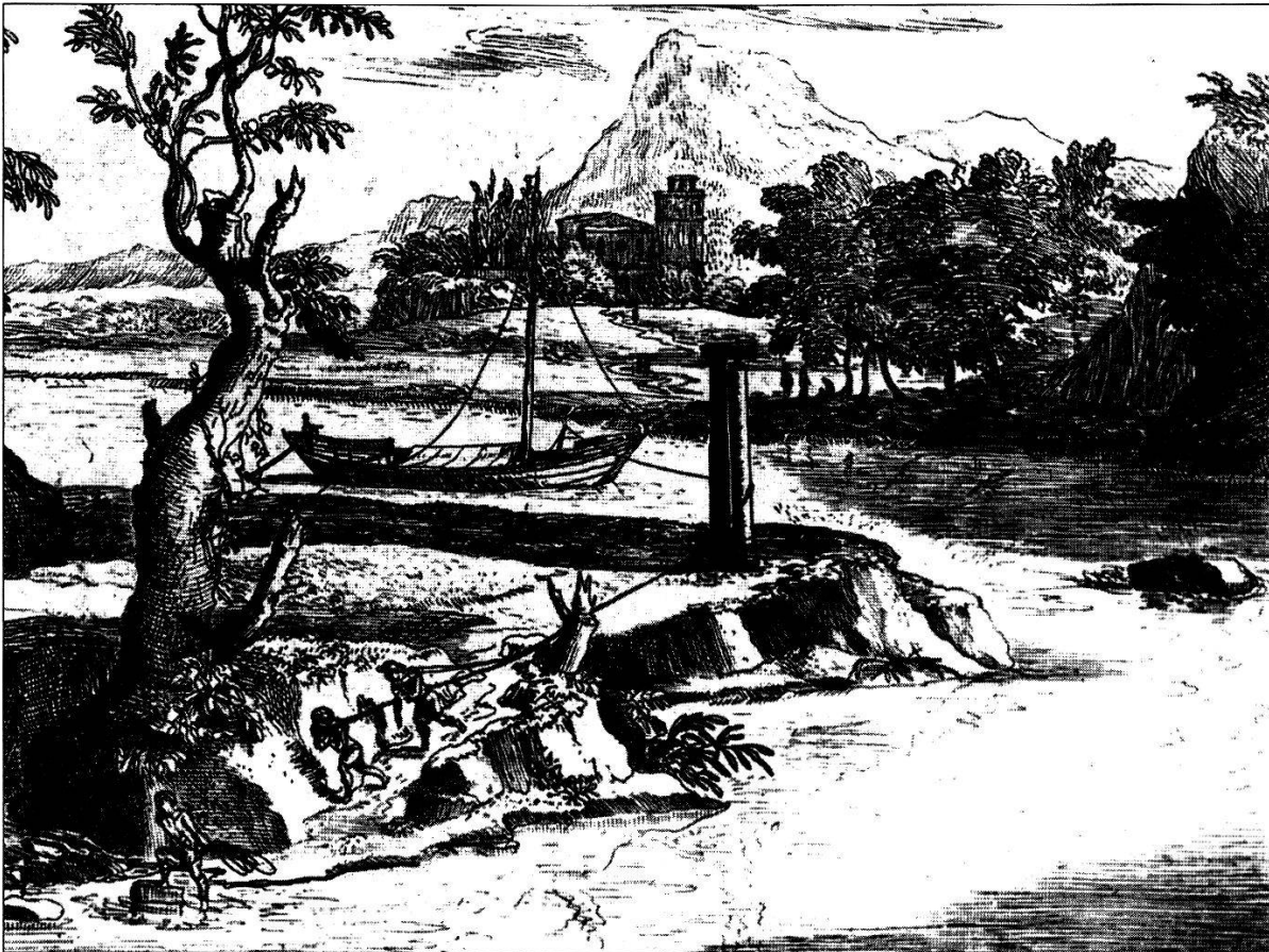
Abb. 1: Treideln (bergwärts ziehen) eines Schiffs durch eine enge Flussbiegung mit Hilfe einer Umlenkrolle für das Zugseil. Illustration aus dem Jahre 1696.
