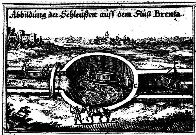
A. Herauff fahrende Schiffe, B. Hinabfahrende Schiffe, C. Hier wirts zugefloßen, so füllt sich die Schleüse D. und erhebt das Schiffe E. das es dem Fluß F. gleich steht und also farthün fehet.
