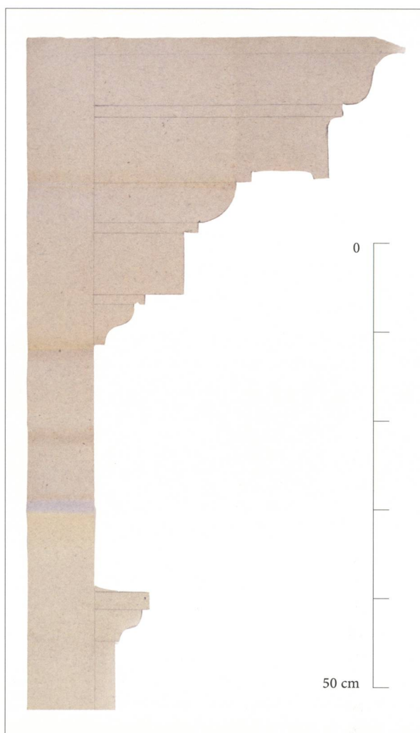
Abb. 1: Schablone für ein Hauptgesims aus dem Nachlass Jost Kopps. Der dünne Karton ist in Tinte mit: «Nach denen zu Reichenthal auf 20. Nürnberger / Werk Schuo» beschriftet. (Nachlass Jost Kopp. Archiv des Schlossmuseums Beromünster. Fotos: Martin Gantner/Jasmin Schäfer, ETH Zürich.)
