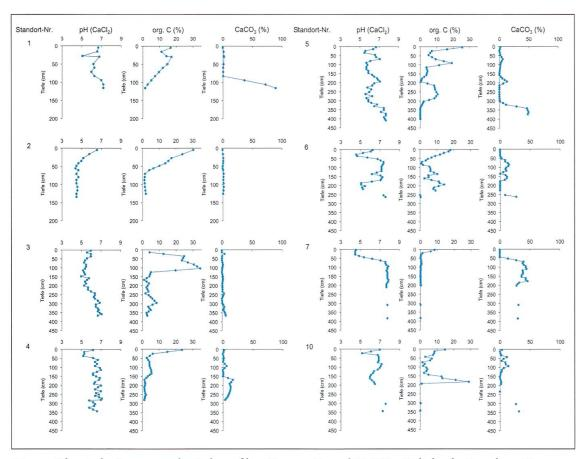
Fig. 10: Chemische Parameter der Bohrprofile: pH-, org. C- und CaCO3-Gehalte der Standorte Nr. 1 - 10 (vgl. Fig. 5).
