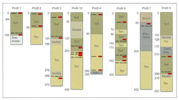
Fig. 9: Profilbeschreibung der entnommenen Bohrkerne. Eingezeichnet ist die stratigraphische Lage der zur Altersdatierung entnommenen Proben (rote Balken) inkl. deren <sup>14</sup>C-Alter (Lage der Profile vgl. Fig. 5; Datierungsergebnisse vgl. Tab. 1).
