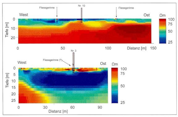
Fig. 11: Geoelektrische Tomogramme (Widerstandswerte in  $\Omega m$ ) entlang der Profillinien am Bohrstandort Nr. 10 (oben) und Nr. 3 (unten). Blau eingefärbte Schichten weisen auf erhöhten Wassergehalt hin, rot eingefärbte Schichten hingegen auf relative Trockenheit.
