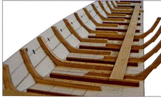
Abb. 13: Rekonstruktion Unter matt-Wrack 2007, Blick in Bugrichtung am Modell 1:20, Blindboden mit einer Planke angedeutet. Alternierend je ein Nadelholz und zwei Gürben, an Bug und Heck je ein Jochbalken (Modellbau: Ivan Trtanj, Kressbronn D, 2007).
