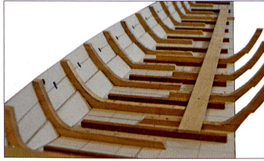
Abb. 13: Rekonstruktion Untermyatt-Wrack 2007, Blick in Bugrichtung am Modell 1:20, Blindboden mit einer Planke angedeutet. Alternierend je ein Nadelholz und zwei Gürben, an Bug und Heck je ein Jochbalken (Modellbau: Ivan Trtnaj, Kressbronn D, 2007).
