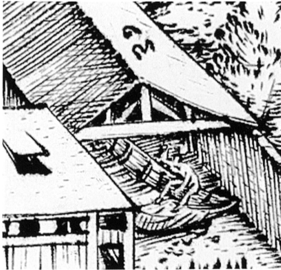
Abb. 18: Bootsbauer in der Luzerner Schiffhütte, Ausschnitt aus dem Luzerner Stadtprospekt von Martinus Martini, um 1580 (StALU, PL 5255). Möglicherweise ist ein Bootsbauer beim Kalfatern (Abdichten der Planken) dargestellt, indem er Dichtungsmaterial wie Moos zwischen die Planken schlägt.
