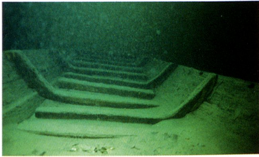
Abb. 12: Unter matt-Wrack, vorderes Schiffsdr Drittel in Bugrichtung mit Kiesladung. Am Boden sichtbar die alternierend angebrachten Nadelhölzer und Gürben, welche die Bodenplanken zusammenhalten und dem Schiff die Form geben (Foto: Heidi Hostettler).
