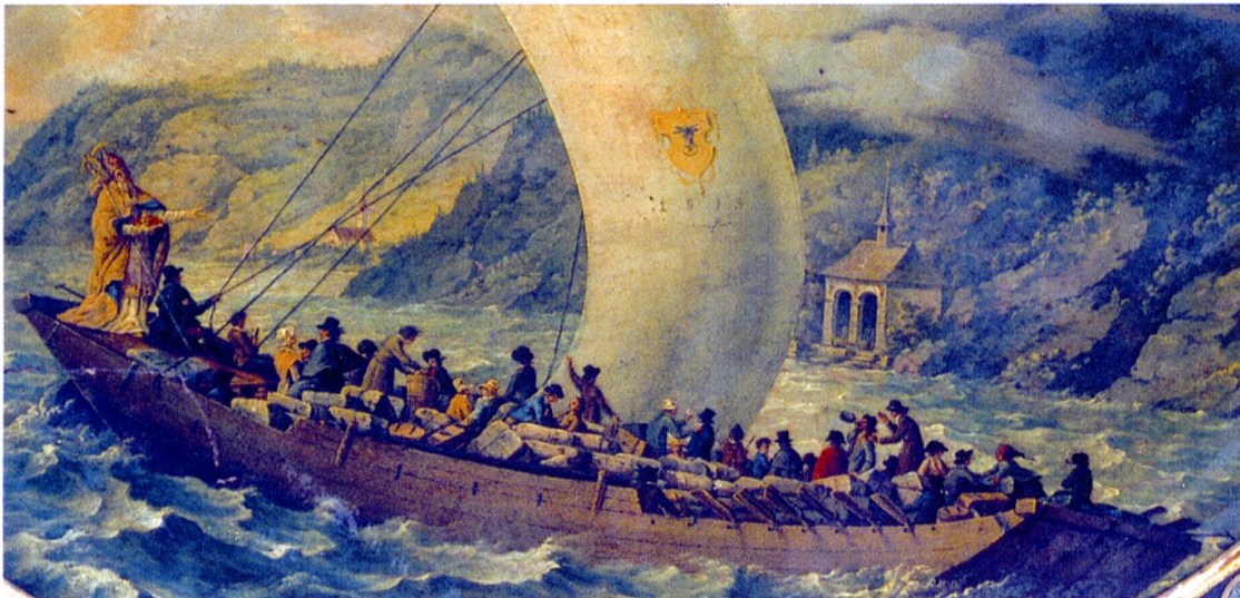
Abb. 17: Grosser Lastensegler, sogenannter Urnernaue, frühes 19. Jahrhundert, mit zusätzlich aufgesetzten Läden zur Erhöhung der Bordwand mittschiffs. Ebenfalls gut sichtbar das Fall und die Brassen (Seile, mit denen Rah und Segel am Wind ausgerichtet werden). Beim Segeln vor dem Wind bleiben die Fahruder eingezogen (Ausschnitt, Original im Historischen Museum Uri).
