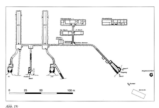
Übersichtsplan A 2206, Abteilung für Genie und Festungen, Technischer Dienst 2 Kriens, Plan-Nr. 25506 vom 27. 5. 1977. Anlageplan mit den Umbauten von 1949–1959, vgl. dazu Abb. Nr. 10. Man sieht den so genannten neuen Auspuffstollen vom Munitionsmagazin 1 (MM1) mit direkter Aussenmündung, den kleinen Antennenstollen beim Beobachter (Beob) und die so genannten Expansions- und Nuklearkammern an der Verzweigung zwischen Haupt- und Unterkunftsstollen (Planarchiv FWK Sek 53, Goldau).
