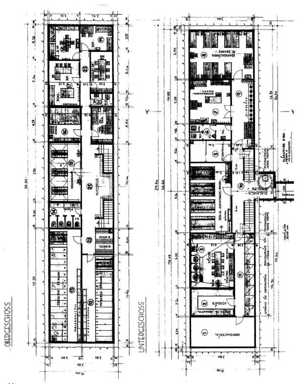
Abb. 21: A.W. Vitznau, Unterkunftsraum für 100 Mann, Bureau für Befestigungsbauten, Plan-Nr. 16901 vom 23.5.1943. Der Unterkunftstrakt, wie er im Zweiten Weltkrieg ausgeführt wurde. Danach wurden einige Änderungen vorgenommen, besonders im Bereich des Vorrats- und Sanitätsraums (Planarchiv FWK Sek 53, Goldau).
