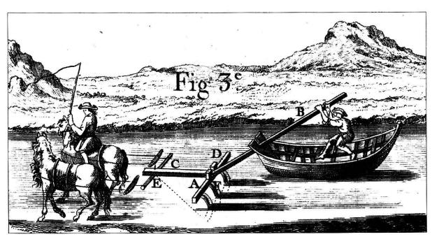
Abb. 2: Aufkratzen des Flussbetts mit einem einfachen Werkzeug (ähnlich einem Pflug oder Rechen). Mit dieser einfachen Technik konnten mit Hilfe der Strömung, die das aufgewühlte Material forttrug, seichte Stellen vertieft werden. Ausschnitt aus einer Bildtafel aus dem Jahre 1753.
