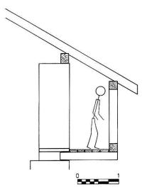
Abb. 3: Meierturm von Silenen. Schnitt durch den Laubengang. Es ist deutlich zu erkennen, dass eine grössere Dachneigung den Laubenumgang unbegehbar machen würde.
