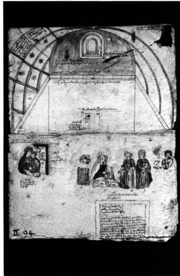
Abb. 76, 77: Loretokapelle Biberegg SZ. Aquarellierte Federzeichnungen. Links: Backstein in Originalgrösse, darunter die Kapellenrückwand mit dem sog. Engelsfenster; rechts: die Wand mit dem hl. Kamin, darüber das Gewölbe, unten die südliche Längswand. Möglicherweise 1684 in Loreto angefertigt. Familienarchiv von Reding, Schwyz.
