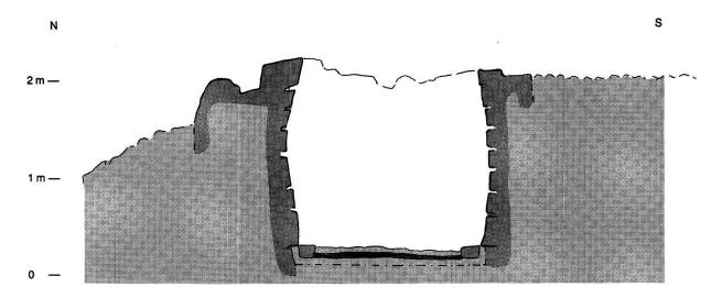
Abb. 3: Kalkofen im Biel, Isenthal: Querschnitt
