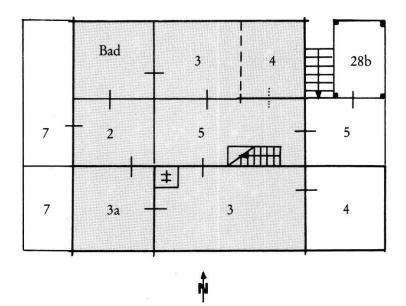
Abb. 17: Schwyz, Hinter Ibach, 1318/42: schematischer Grundriss, Erdgeschoss (ohne Massstab). Gerastert: Kernbau; 2: Küche; 3: Stube; 3a: Nebenstube (Schlafzimmer); 4: Kammer; 5: Gang; 7: Laube; 28b: (Holz-)Schopf. Erklärung der zeichnerischen Details siehe S. 199.
