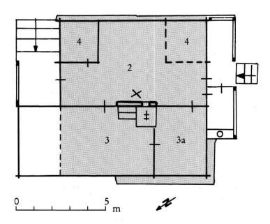
Abb. 25: Seelisberg, Buchholz, 1340/43: schematischer Grundriss, Erdgeschoss. Gerastert: Kernbau; 2: Küche; 3: Stube; 3a: Nebenstube (Schlafzimmer); 4: Kammer. Erklärung der zeichnerischen Details siehe S. 199.
