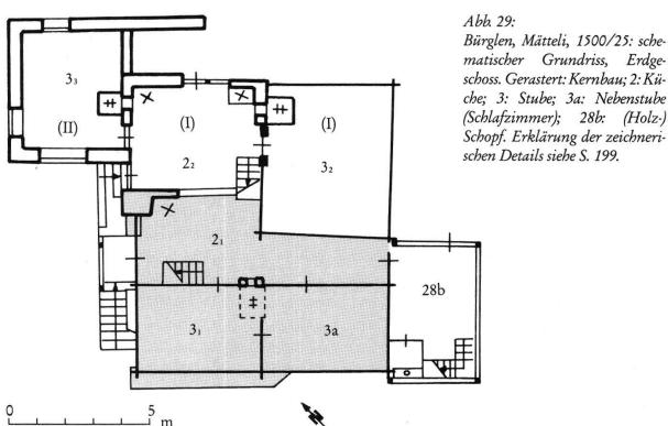
wurde die originale giebelseitige Küchenwand des Kernbaus zugunsten einer zweiten Küche entfernt. Kernbau mit Stube und Nebenstube im Vorderhaus. Rauchküche und kleine Kammer im Hinterhaus. Bohlen-Balkendecke mit einer kräftigen Rille in der Nebenstube. – Kammergeschoss: Im Kammergeschoss des Kernbaus ursprünglich dieselbe Raumaufteilung wie im Erdgeschoss. Traufseitige Lauben teilweise entfernt.
