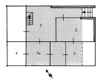
Abb. 21: Schwyz, Chaltbach, 1319/43: schematischer Grundriss, Erdgeschoss (ohne Massstab). Gerastert: Kernbau; 2: Küche; 3: Stube; 3a: Nebenstube (Schlafzimmer); 4: Kammer; 5: Gang. Erklärung der zeichnerischen Details siehe S. 199.
