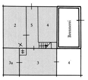
Abb. 13: Steinen, Lauigasse 21/Büel, 1305: schematischer Grundriss, Erdgeschoss (ohne Massstab). Gerastert: Kernbau; 2: Küche; 3: Stube; 3a: Nebenstube (Schlafzimmer); 4: Kammer; 5: Gang. Erklärung der zeichnerischen Details siehe S. 199.
