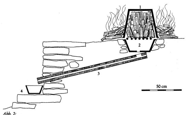
Abb. 2: Schematische Darstellung des Harzbrennens: 1: Harzholz unter Isolationsgefäss; 2: Sammelbecken mit Rost; 3: Holzteuchel; 4: Kühlgefäss.
