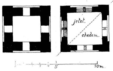
Abb. 3. Turm der Pfarrkirche von Bürglen (Uri). Grundrisse des 5. und 6. Stockwerks. (Nach Aufnahmen von Herrn Nationalrat Schmid v. Böttstein.) Maßstab 1:200.
