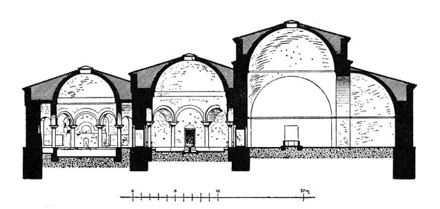
Abb. 5. Grundriß und Längsschnitt des Eski Kaplıca-Bades in Prusa am Olymp mit Apodyterium (rechts), Tepidarium (Mitte) und Calidarium (links). Aufnahme aus: H. Wilde, *Brussa* (Beiträge zur Bauwissenschaft, Heft 13), Berlin 1909, Abb. 117/118
