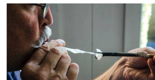
Les yeux de verre n'étant pas sphériques, l'artisan doit aspirer la partie postérieure.
