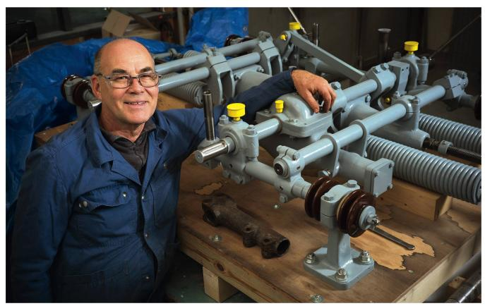
C'est avec une minutie d'orfèvre que le retraité a démonté, puis numéroté chaque pièce. Le pantographe participera à la résurrection de la célèbre automotrice.
