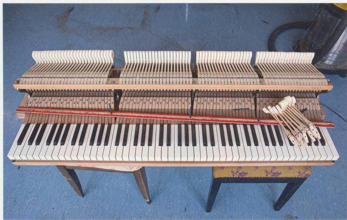
chir par divers procédés ou les remplacer avec de l'ivoire prélevé sur un vieux clavier ou provenant d'un cimetière de mammouths découvert en Russie. Il remplace aussi les pièces de cachemire tapissant les mortaises, ces minuscules orifices dans lesquels s'insèrent des tiges qui maintiennent les touches dans leur axe. Un travail de bénédiction...
