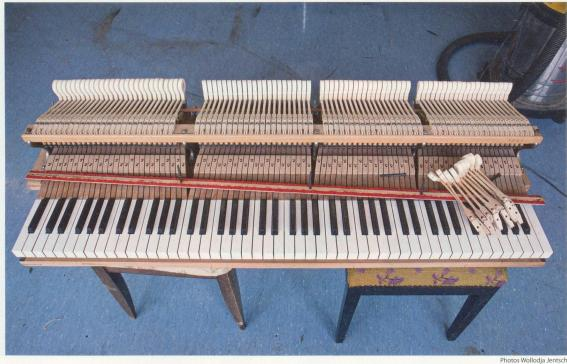
Le clavier d'un piano à queue remis à neuf. Les touches ont été blanchies sous une lampe fluorescente, puis à l'eau oxygénée. Reste à poser quelques marteaux.
