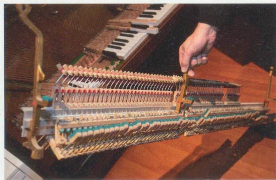
Le clavier d'un piano à queue remis à neuf. Les touches ont été blanchies sous une lampe fluorescente, puis à l'eau oxygénée. Reste à poser quelques marteaux.
