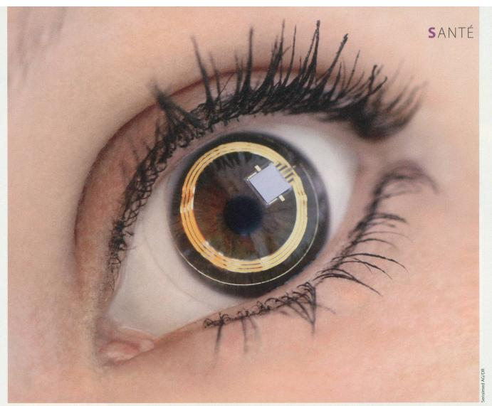
Sur un verre de contact, le capteur Triggerfish, créé par la société vaudoise Sensimed est une solution innovante pour le monitorage de la pression intraoculaire. Elle est mesurée en continu pendant 24 heures et facilite ainsi le diagnostic et le traitement du glaucome.
