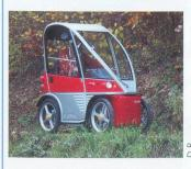
Les véhicules Classic, Le modèle de base à 3 roues a une autonomie de 40 à 65 km et sa vitesse peut atteindre 30 km/h. Toiture amovible en option. Temps de recharge: 8 h. Prix: dès Fr. 12 500.—.
