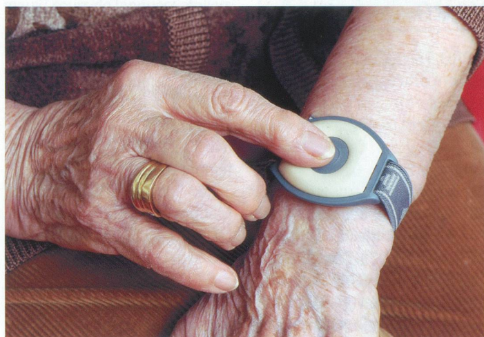
Une pression sur la touche du bracelet alerte immédiatement la centrale de la Croix-Rouge.
