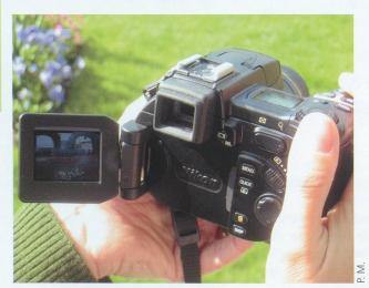
Les appareils numériques possèdent deux viseurs, un moniteur qui permet de voir l'image qu'on vient de saisir et un viseur traditionnel, comme les argentiques.
