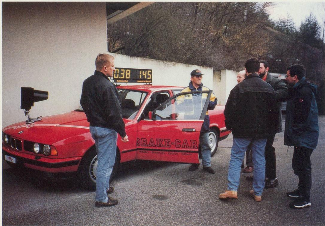
*Une voiture spéciale au centre ACS de Veltheim (AG) permet de tester les réflexes des conducteurs. Au signal, il faut enfoncez la pédale des freins le plus fort et le plus rapidement possible. Ici, l'élève a mis 38/100<sup>e</sup> de secondes pour une poussée de 145 kg.*
