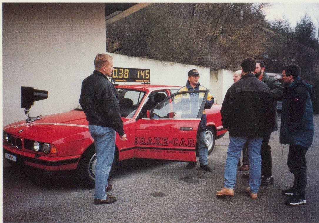
*Une voiture spéciale au centre ACS de Veltheim (AG) permet de tester les réflexes des conducteurs. Au signal, il faut enfonce la pédale des freins le plus fort et le plus rapidement possible. Ici, l'élève a mis 38/100° de secondes pour une poussée de 145 kg.*
