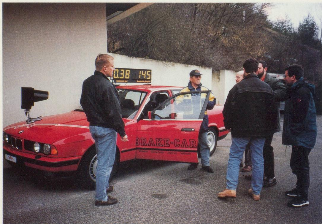
*Une voiture spéciale au centre ACS de Veltheim (AG) permet de tester les réflexes des conducteurs. Au signal, il faut enfonce la pédale des freins le plus fort et le plus rapidement possible. Ici, l'élève a mis 38/100<sup>e</sup> de secondes pour une poussée de 145 kg.*
