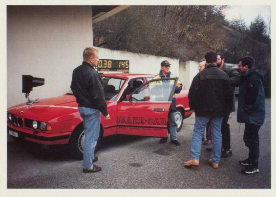
Une voiture spéciale au centre ACS de Veltheim (AG) permet de tester les réflexes des conducteurs. Au signal, il faut enfoncer la pédale des freins le plus fort et le plus rapidement possible. Ici, l'élève a mis 38/100° de secondes pour une poussée de 145 kg.
